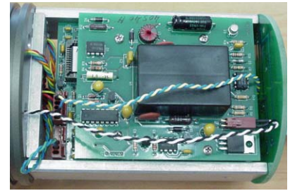
Top end cap - Optional G.O. 1015 Rosette PCB (above Modem PCB)
